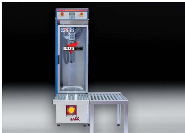
Agitatore a colonna professionale che viene posizionato direttamente sul fianco del tintometro per la miscelazione in linea e che permette una miscelazione a bassa velocità senza alterare la struttura di rivestimenti, quarzi lavabili, ecc.
